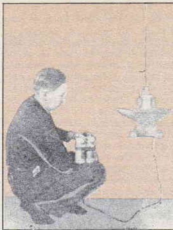
Il peso di questa incudine di circa 30 chili è sostenuto, invece, dal magnete a ferro di cavallo, alimentato con 3 volt.
