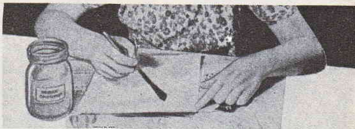
Applicazione di uno strato di soluzione di gommalacca, in alcool, sullo strato di amido idrolizzato, precedentemente applicato sulla carta di supporto
